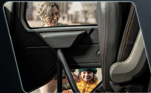
El área translúcida en la puerta permite la visualización de obstáculos en el costado del vehículo.
