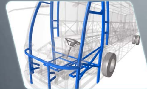
Célula de supervivencia del conductor. (Opcional)
