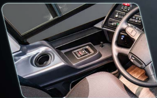
Novo revestimento interno com compartimentos adicionais para objetos destinados ao motorista.
