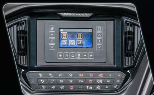
Novo sistema multiplex com botões de auxílio e teclado de acesso rápido.
