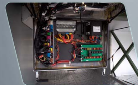
Roteamento de chicotes elétricos otimizado, facilitando manutenção e distribuição dos componentes eletrônicos.
