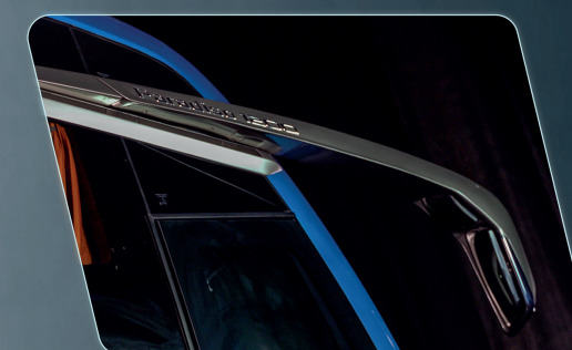
Tiara em plástico injetado e aço inox, garantindo leveza e fácil manutenção.
