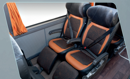
Poltronas com novo sistema por pistão, com reclinção suave e fácil acesso e manutenção.
