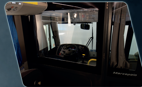
Parede de separação remodelada, com novo sistema de abertura.
